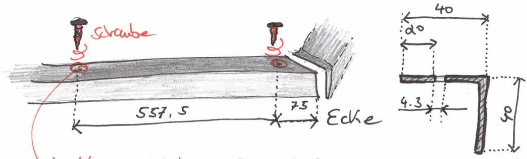
→ Kurzstufenbohrer  $\varnothing = 4,3 \text{ mm}$
